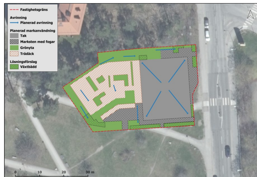
Figur 12–1. Föreslagen dagvattenhantering för fastigheten: 87 m² växtbäddar.
