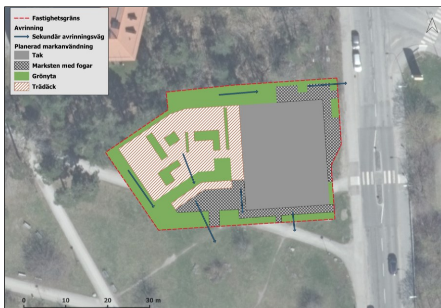
Figur 11-2. Sekundära avrinningsvägar för planerad exploatering.
