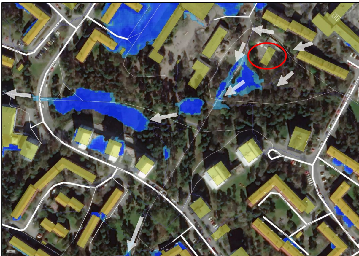
Figur 14. Översikt visande instängda lågpunkter (blåa områden) nedströms utredningsområdet (röd markering) modellerat i översvämningsmodellen Scalgo Live (Marktema 2020). Gråa pilar illustrerar rinnriktning hos de ytliga rinnvägarna. Den närmst liggande lokala lågpunkten söder om utredningsområdet har en uppehållsvolym på 87m 3 enligt beräkningar i Scalgo Live.
