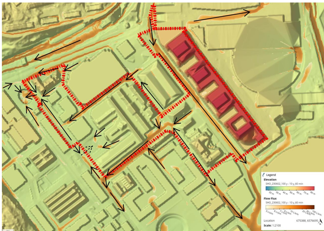
Figur 10 Avrinningsvägar vid framtida situation inom samt in och ut ur detaljplanegränsen för Dp 2a. Svarta pilar indikerar generell flödesriktning. Streckad pil indikerar sekundär flödesväg. Nyanser av orange indikerar olika storlekar på flödet, större flöden vid mörk nyans.
