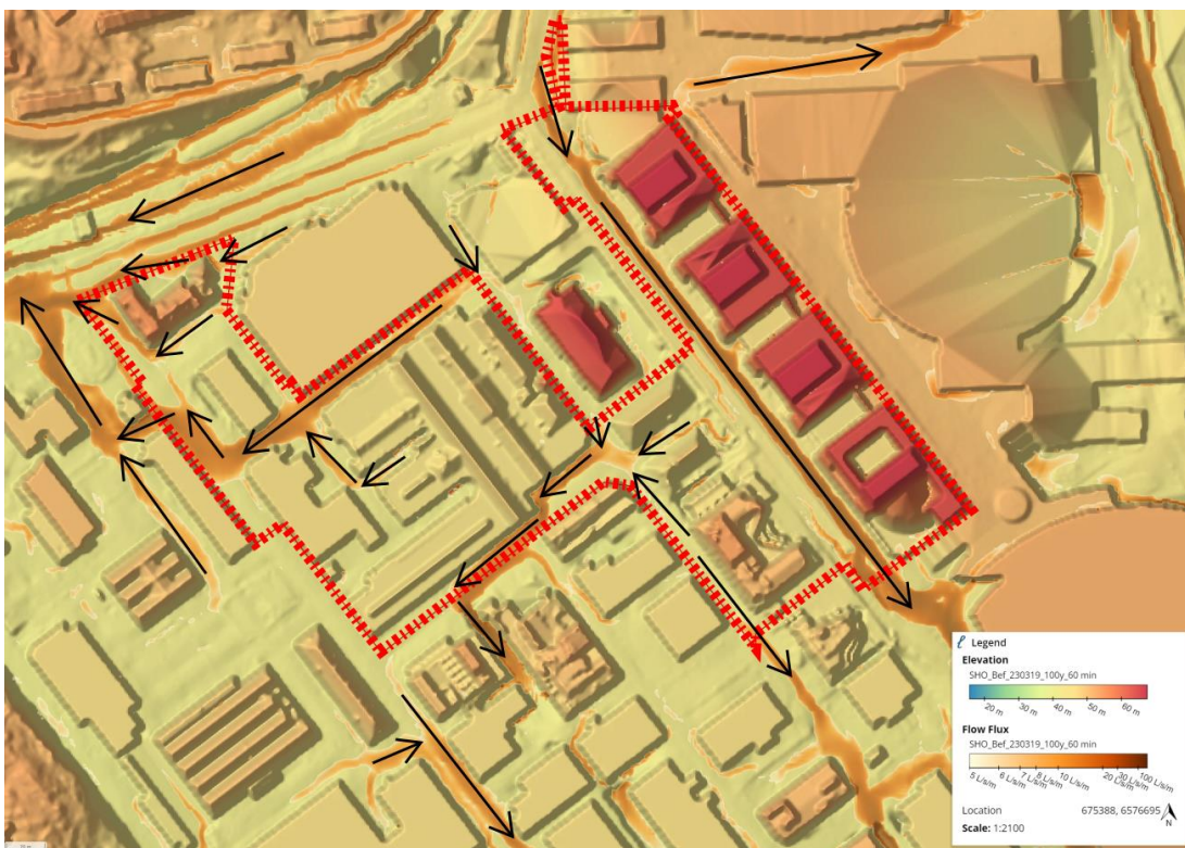
Figur 8 Avrinningsvägar vid befintlig situation in och ut ur detaljplanegränsen för Dp 2a. Svarta pilar indikerar generell flödesriktning. Nyanser av orange indikerar olika storlekar på flödet, större flöden vid mörk nyans.
