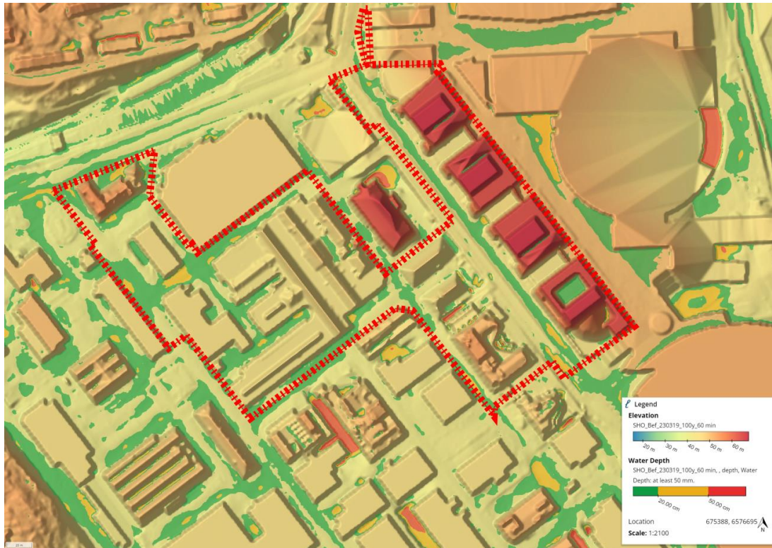
Figur 9 Maxvattendjup vid befintlig situation inom och runt om detaljplanegränsen för Dp 2a. Vattendjup enligt följande; grön = 0,05-0,2 m, gul = 0,2-0,5 m, röd = >0,5 m
