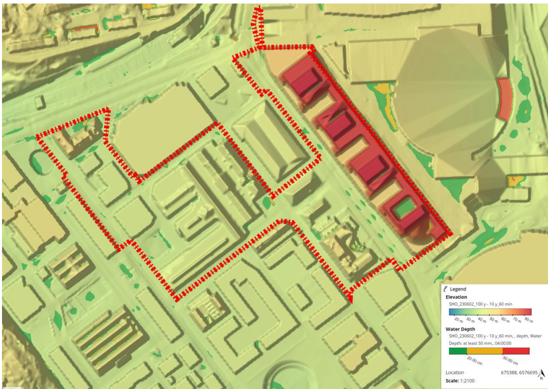
Figur 12 Vattendjup vid framtida situation inom och runt om detaljplanegränsen för Dp 2a vid skyfallssimuleringens slutpunkt. Vattendjup enligt följande; grön = 0,05-0,2 m, gul = 0,2-0,5 m, röd = >0,5 m
