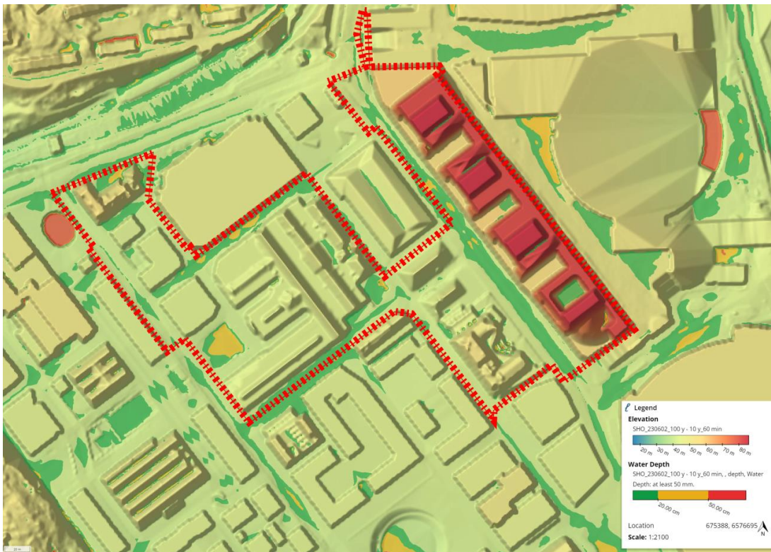
Figur 11 Maxvattendjup vid framtida situation inom och runt om detaljplanegränsen för Dp 2a. Vattendjup enligt följande; grön = 0,05-0,2 m, gul = 0,2-0,5 m, röd = >0,5 m
