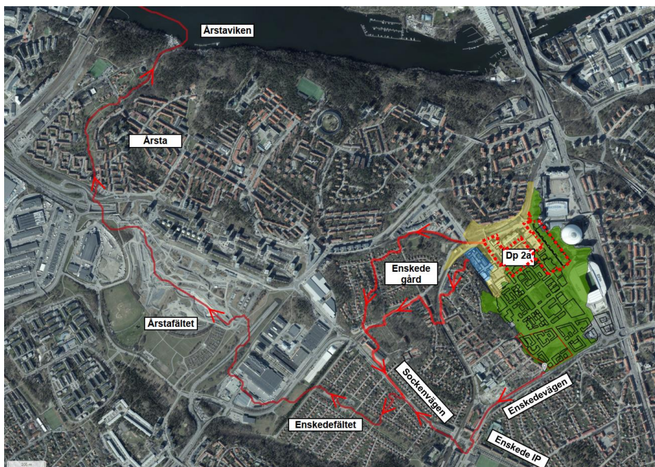
Figur 2 Avrinningsområde Södra Slakthusområdet (grön markering), Norra Slakthusområdet (gul och blå markering) och deras respektive teoretiska avvattningsriktning i riktning mot Årstaviken (svagare röd linje med pilar för flödesriktning). För de teoretiska avrinningsvägarna tas ingen hänsyn till lokala lågpunkter längs vägen. Baseras på befintlig situation. Planområdesgräns Dp 2a i röstreckad linje. Källa: SCALGO Live, 2023-01-30
