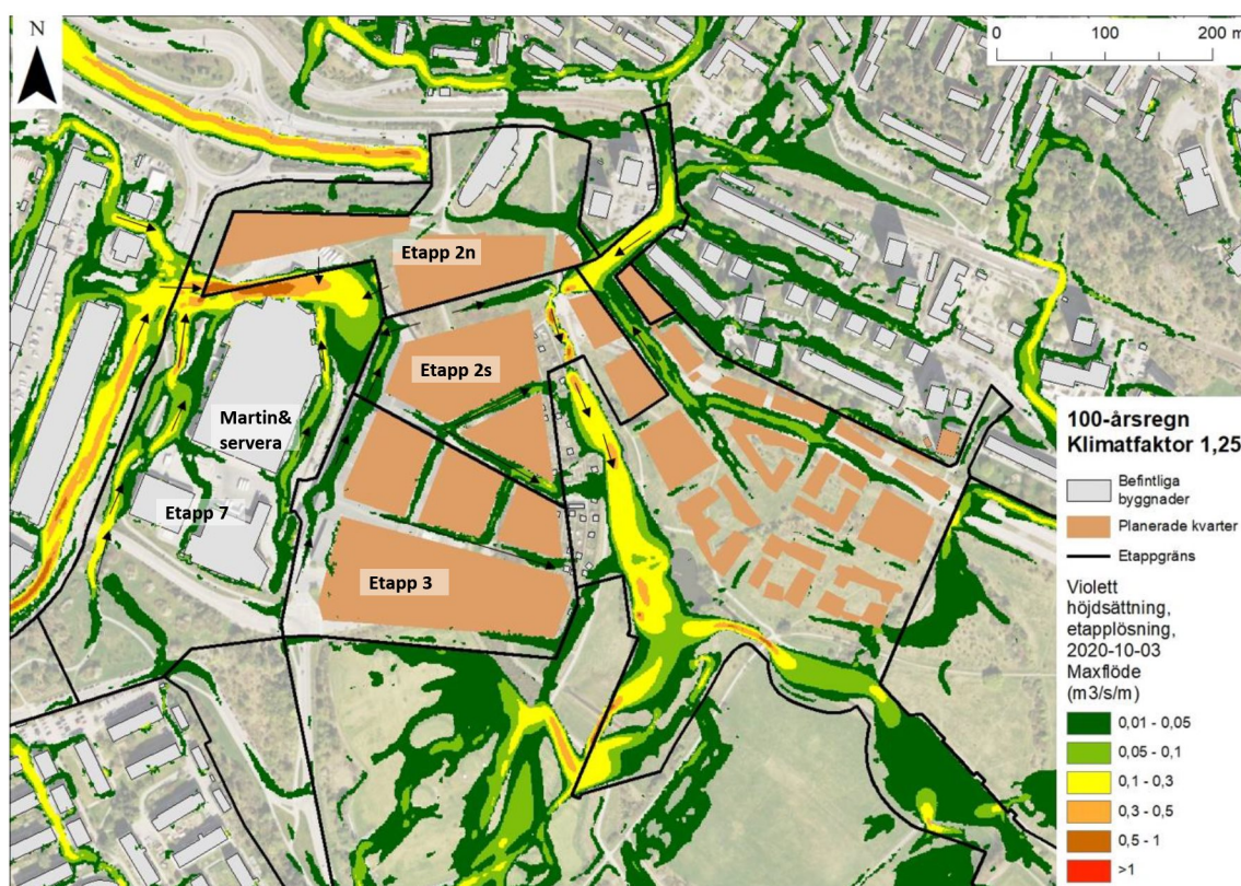
Figur 5. Maximalt flöde (m³/s/m) vid 100-årsregn med klimataffaktor 1.25, efter utbyggnad, utan etapp 7.
