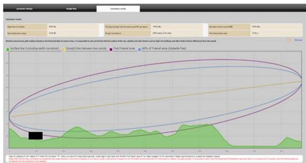
Figur 10. Beräknad Fresnel-zon för sändare norr om Bromma flygplats till mottagare ca 100 m över marken vid 5 km avstånd, via byggnationen (svart objekt vid ca 400 m).
