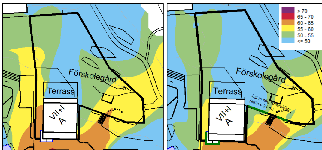
Figur 21. Dagekvivalent ljudnivå (kl 06-18) på skolgård med och utan 2,5 m höga skärmar. Beräkningshöjd 1,5 m.
