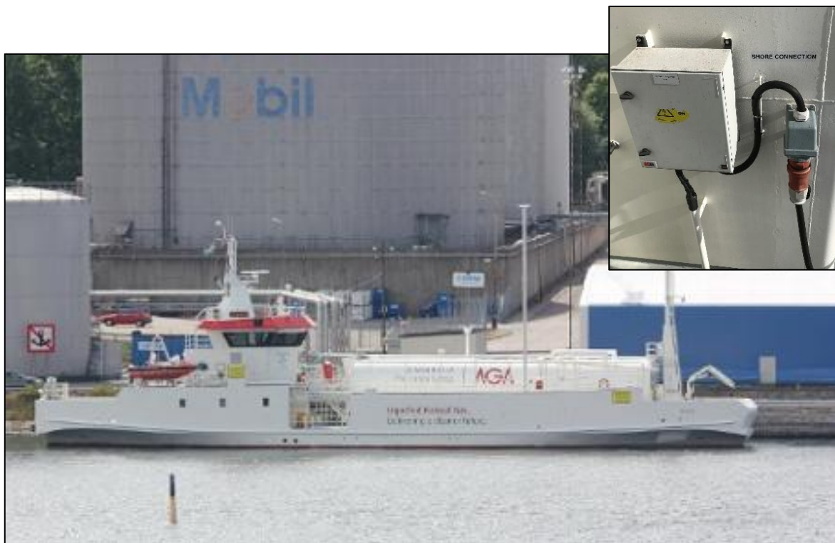
Figur 13. Seagas i hamn. Den lilla bilden visar anslutningen för landström ombord.
