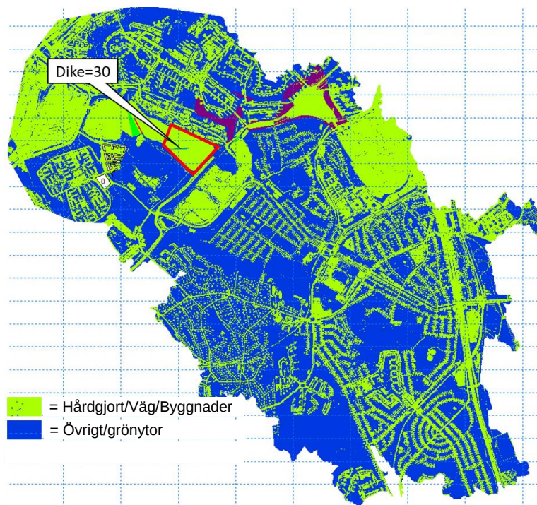
Figur 7. Manningsfil som har använts i skyfallsmodellen. Den röda polygonen visar planområdets ungefärliga läge. Lila ytan runt Årstastråket motsvarar övrigt/grönytor.
