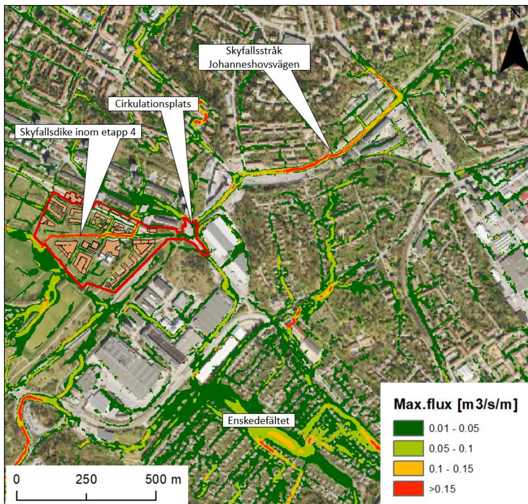
Figur 12. Maximalt flöde (m 3 /s/m) vid 100-årsregn med klimatkfaktor 1,25 – helhetsperspektiv. Skyfallsstråket Johanneshovsvägen leder vatten till cirkulationsplatsen inom etapp 4 som har anpassats för att leda vatten till skyfallsdiket som mynnar i Årstafältets dammanläggning. Den planerade exploatering inom Årstastråket etapp 3 finns med i simuleringen som gör att Johanneshovsvägen blir den stora skyfallsvägen inom avrinningsområdet.
