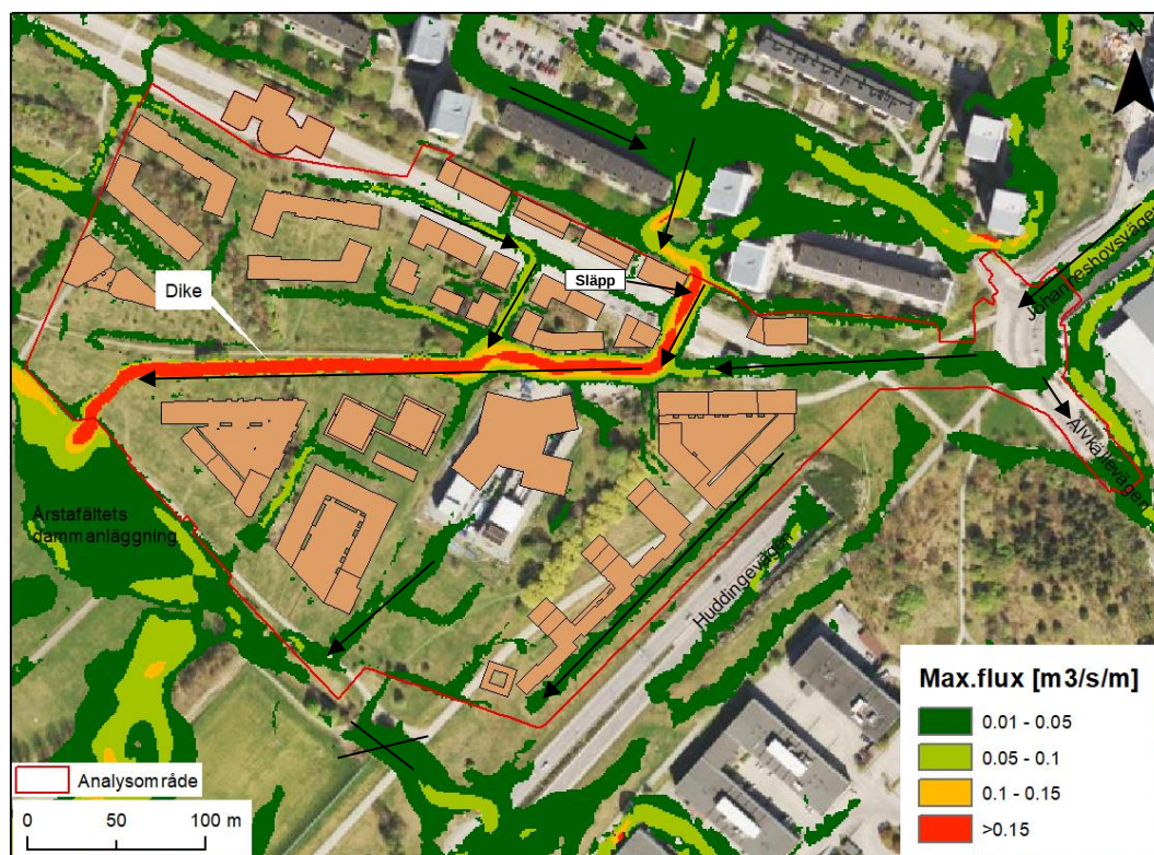
Figur 11. Maximalt flöde (m 3 /s/m) vid 100-årsregn med klimattfaktor 1,25. Orangea polygoner visar nya byggnader. Stora flödesvägar såsom diket rekommenderas hållas fria för att undvika dämningar. Röda linjen motsvarar området där höjdsättningen har ändrats inom etapp 4. Svart kryss markerar triangeltomtens läge.
