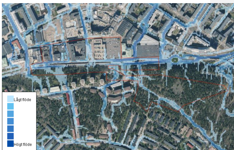
Bild 9. Skyfallskartering – flödesvägar vid 100-årsregn (Stockholm Vatten och Avfall, samt miljöförvaltningen 2018).
