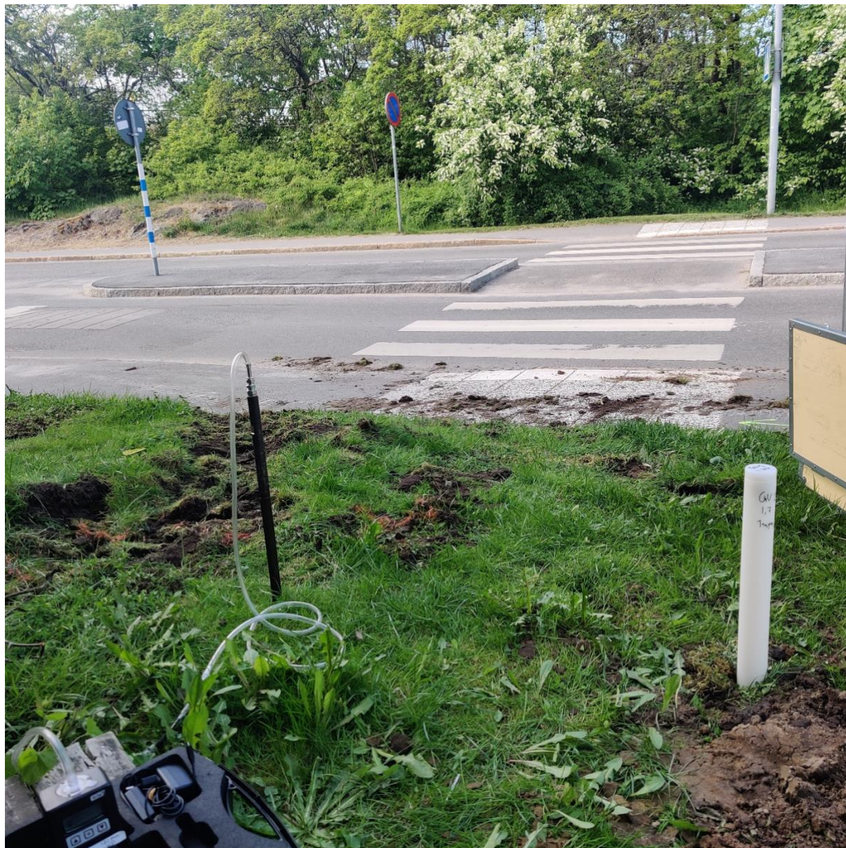
Figur 3: Bild på pumpning samt nedsatt GV-01
