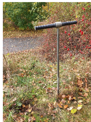
Figur 1. Manuell skruvprovtagning i provpunkt 21GA02.
