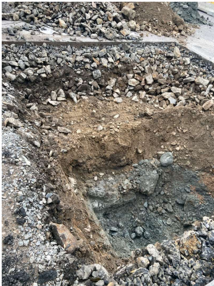
Figur 7. Bild på provgrop 24LCPG03 med olika lager av fyllning till underlagande lera i botten. Notera förekomst av oljeindräkt makadam i nedre högra hörnet av bilden.
