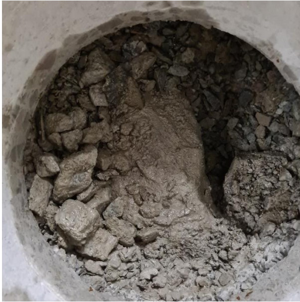
Block i fyllning under betonggolv som förhindrade djupare provtagning i 21HSrv1.
