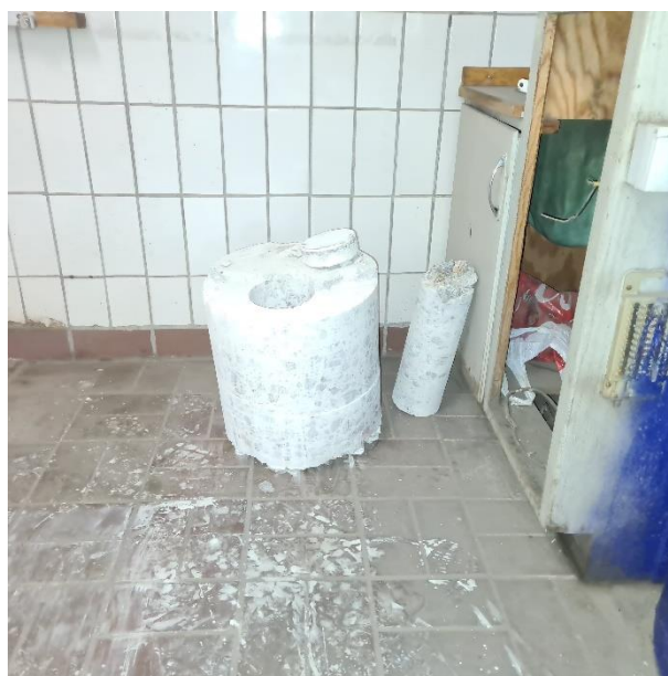
Betongkärna vid 21HSrv2. Ingen synlig nedträngningshorisont.
