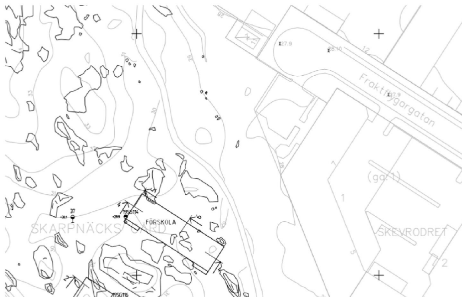
Bild 4. Inmätt berg i dagen vid planerad förskola. Källa: Geoteknisk markundersökning, Structor Geoteknik Stockholm AB, 2019-10-17.
