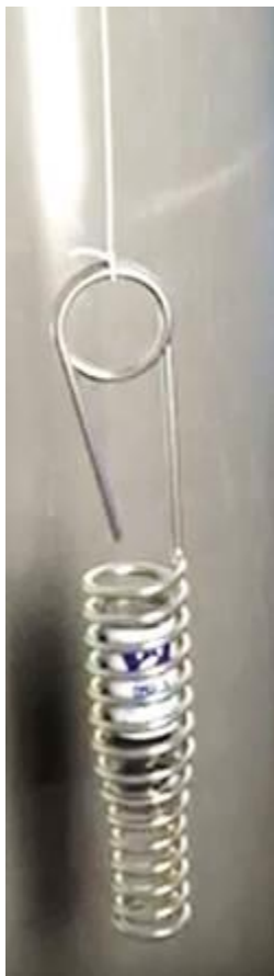
Figur 3: Figur över anordning för passiv mätning.
