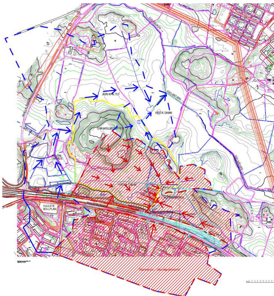
Figur 4.5.1 Karta över Igelbäckens lokala tekniska delavrinningsområde runt Granholmstoppen inklusive avrinningsriktningar. Rastrerat område på ca 80 ha avvattnas idag till Järva dagvattentunnel.
