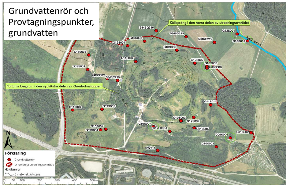
Figur 4.4.1 Grundvattenrör och provtagningspunkter för grundvatten (från Sweco, 2013).
