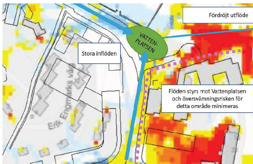
Figur 21. Princip för skyfallshantering, vattenplatsen utgör en central del för att hantera kraftig nederbörd. Översvämningssituationen förbättras något jämfört med nuläget (WSP, 2021). Det fördröjda utflödet i nordost i figuren kommer kräva att ett tillfälligt dike anläggs.
