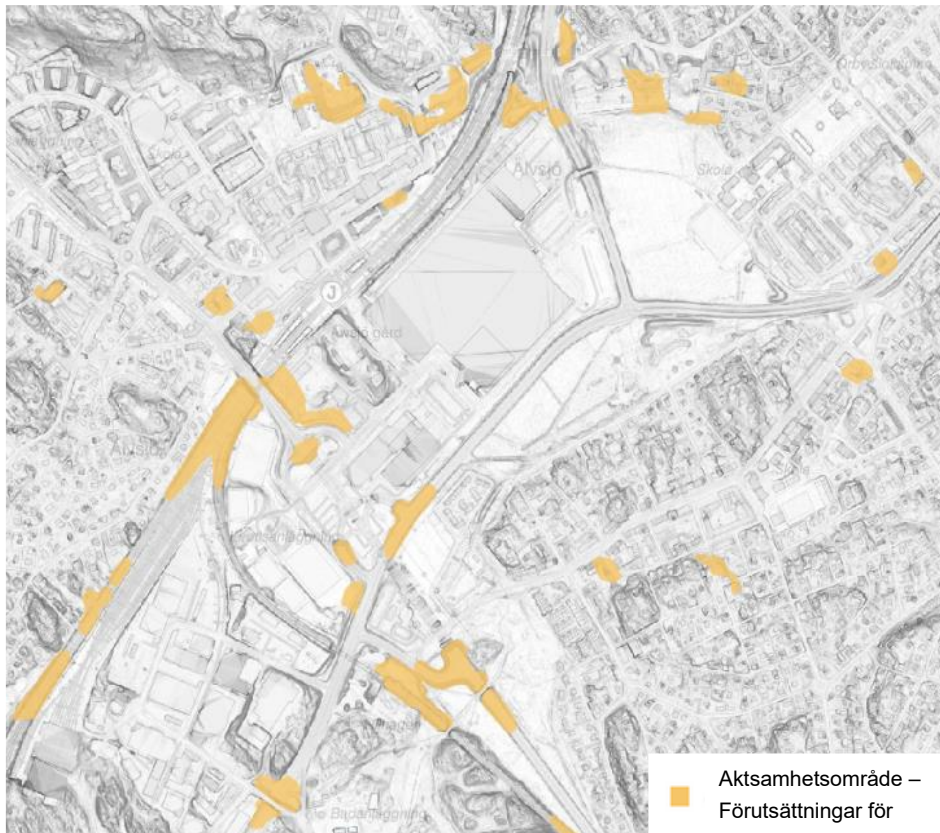
Figur 5-17. Översiktlig kartering som visar platser i och i anslutning till programområdet där förutsättningar finns för skred i finkornig jordart. Källa: SGU, kartverket rasskrederosion.se
