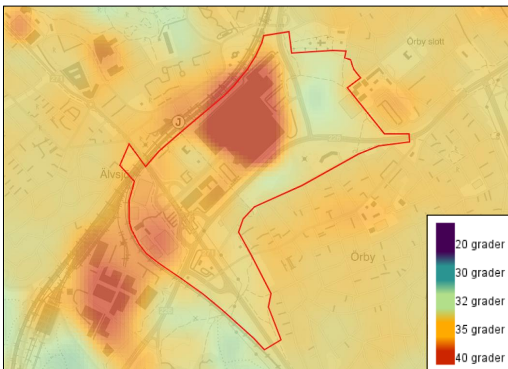
Figur 5-13. Maximal strålningstemperatur, uppmätt 2013–2021. Källa: (Stockholms stad, 2023b).
