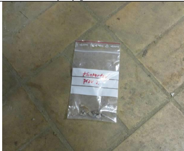
Bild 8. Prov 2, klinkerfog, källare. Ej Asbest.
