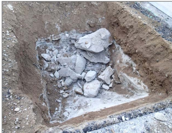
Figur 7. Skumbetong i provgrop 18K48.
