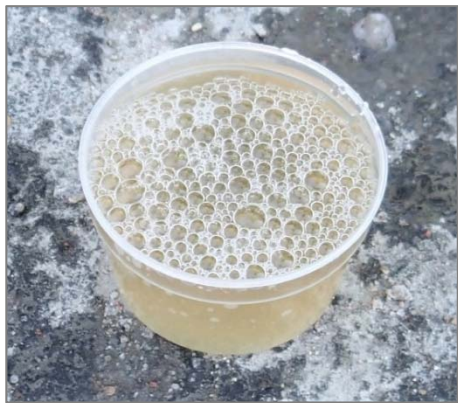
Figur 9. Gul färg och skum på vattnet i rör 18K48, lukt av diesel/olja.
