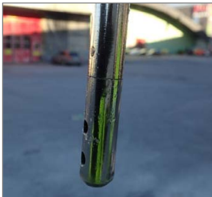
Figur 10. Partiklar på lodet som kan komma från skumbetongen i punkt 18K48.
