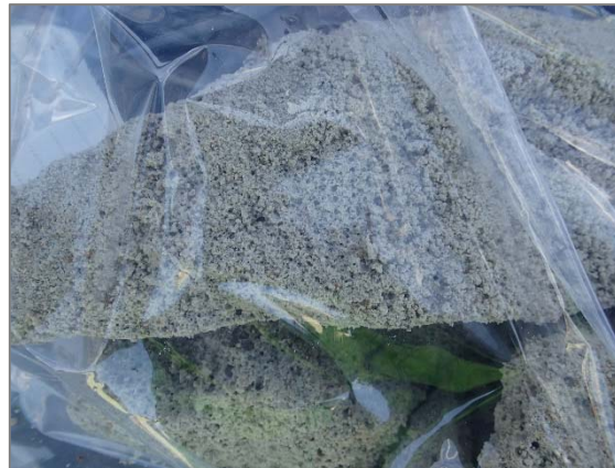
Figur 8. Närbild på den porösa skumbetongen
