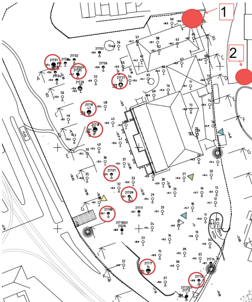
Figur 9. Översiktskarta där radonmätningar med Markus-10 och gammaspektrometer utförts. Icke ifyllda ringar innebär undersökning med primärt Markus-10. Röda helcirkel innebär undersökning med enbart gammaspektrometer.
