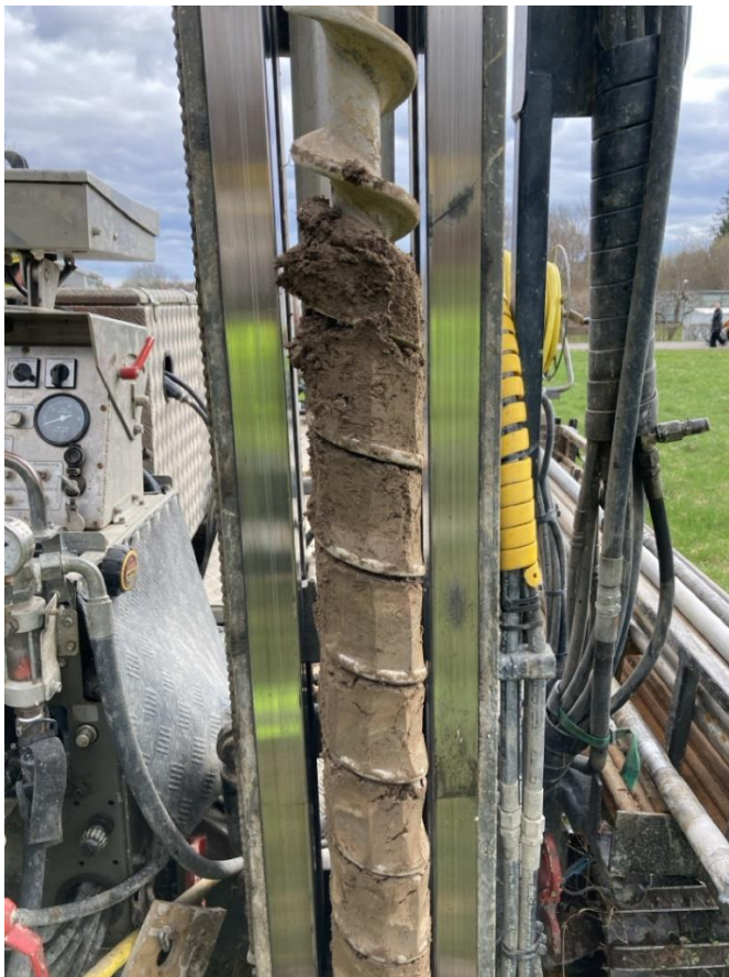
Figur 5 visar bild på skruvborr från provpunkt 24LC08 från marknivå och till ca 1 m. Omblandad fyllning ner till 0,2 meter och därefter naturlig lera.
