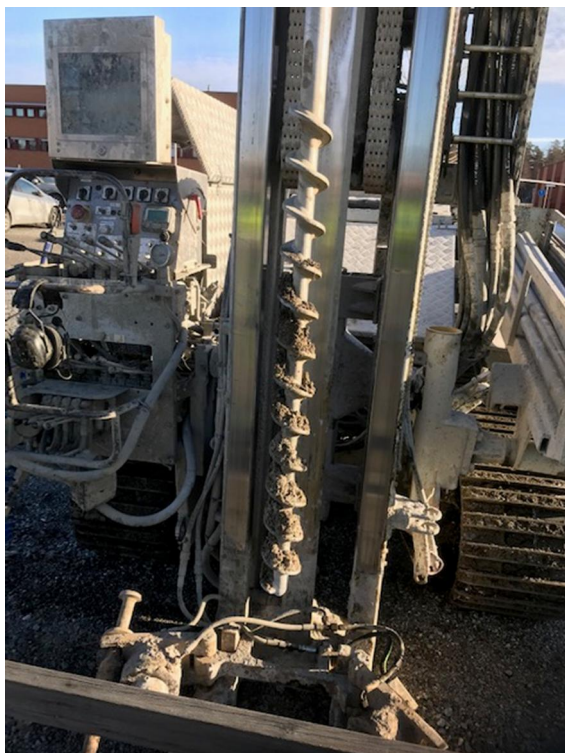
Figur 2 Provpunkt SW1902. Det första lagret av material bestod av grovt grus, vilket medförde att stor del av materialet ramlade ner.
