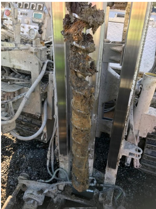
Figur 5 Inslag av träbiter underlagrad av silt och lera vid provpunkt SW1910.
