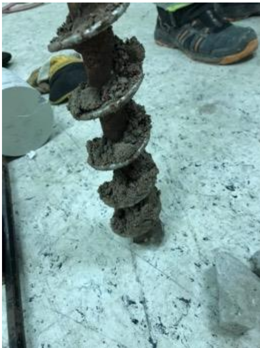
Figur 5 visar den miljöskruv som använts under provtagningen i hus 2 samt det grovkorniga material som provtagits vid Bp 1 och 2.
