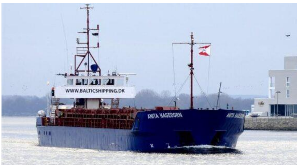
Figur 18. Bulklastfartyget Anita Hagedorn har dimensionerna; längd 75 m, bredd 8,2 m, djupgående 3,7 m och DWT 1 741.
