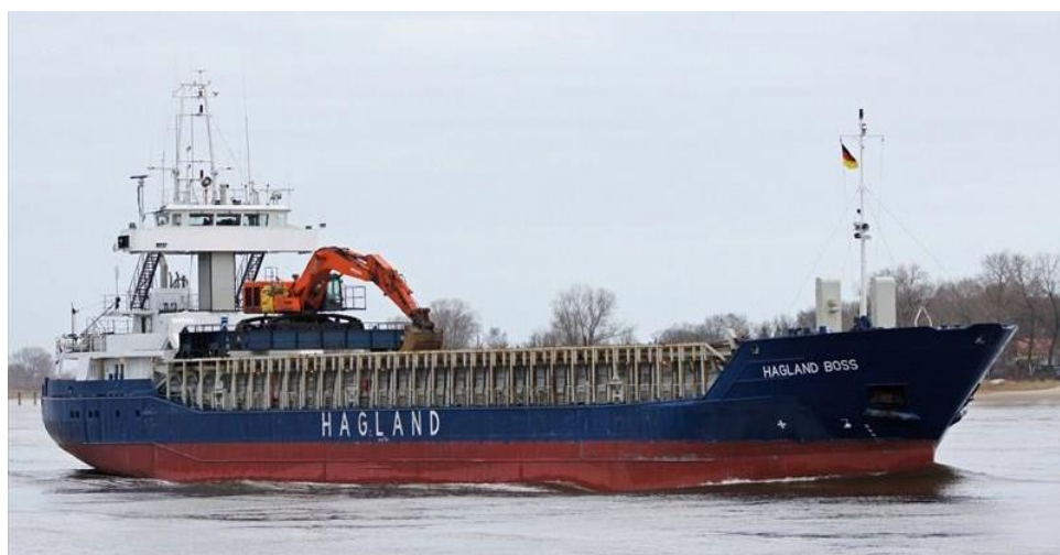
Figur 17. Fartyget Hagland Boss av Vänermax-storlek har dimensionerna; längd 88 m, bredd 12,8 m, djupgående 3,7 – 5,5 m beroende på last och DWT 3 694, [Marine Traffic].
