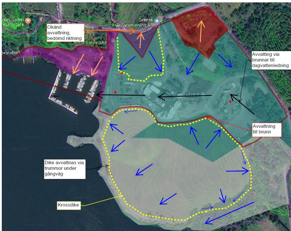
Figur 11. Befintligt område och översiktliga avvattningsvägar. Blå pilar avser avrinningsriktningar från mark och svarta pilar ledningsbunden avrinning. Orangea pilar markerar bedömd avrinningsriktning från områden med okända dagvattenanläggningar.
