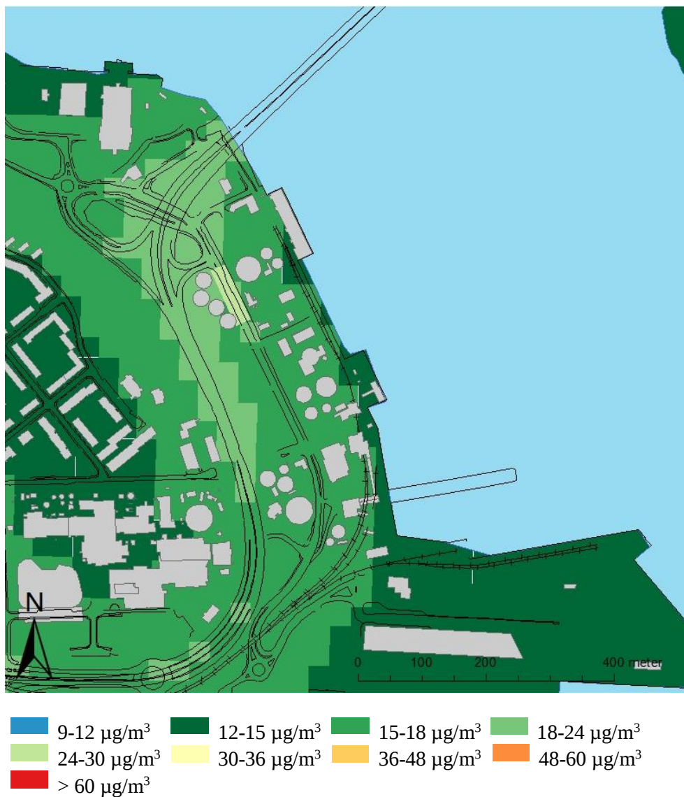
Figur 17. Beräknad dygnsmedelhalt av kvävedioxid, \text{NO}_2 , ( \mu\text{g}/\text{m}^3 ) under det 8:e värsta dygnet för nollalternativet år 2030. Normvärdet som ska klaras är 60 \mu\text{g}/\text{m}^3 .
