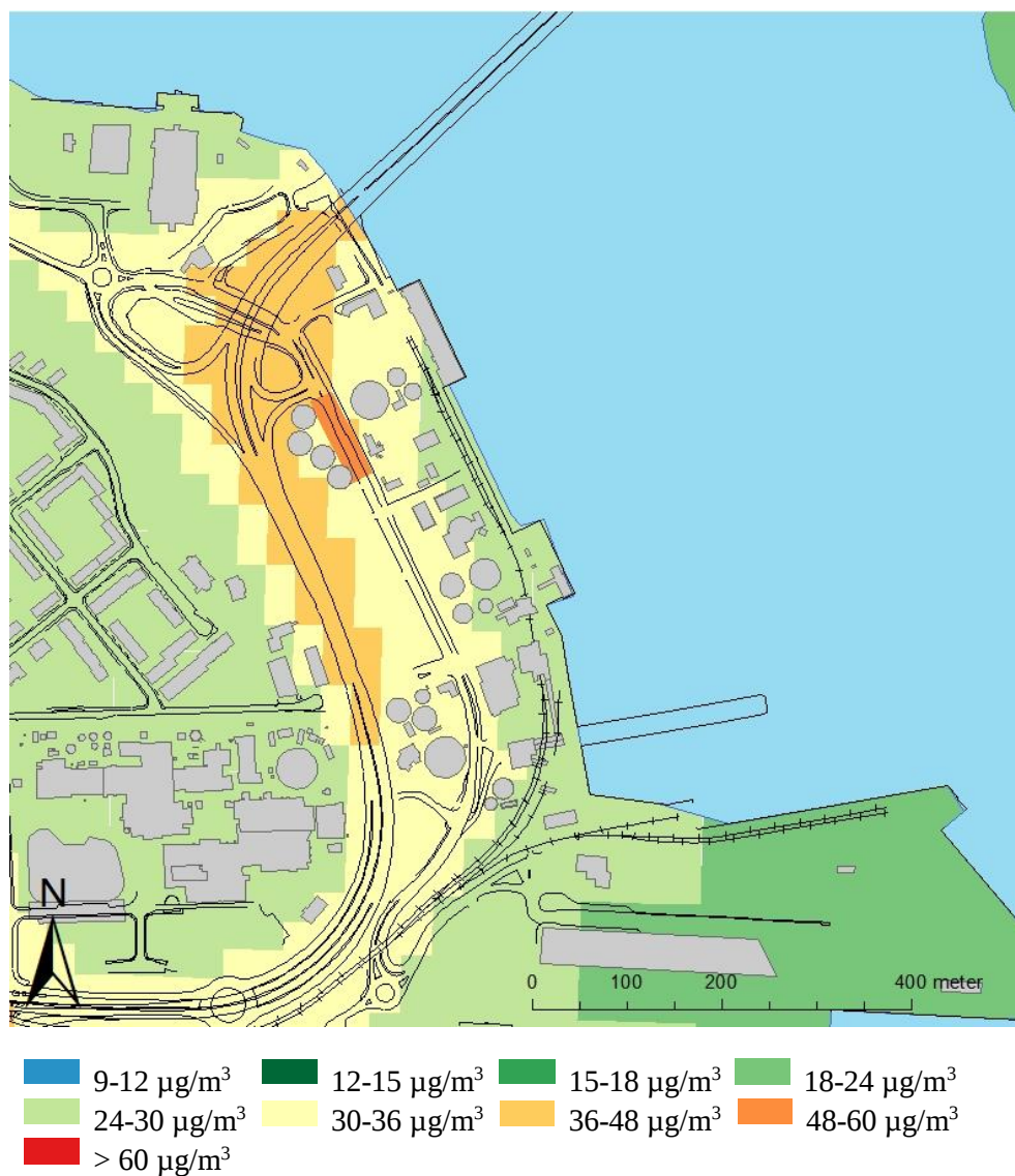
Figur 15. Beräknad dygnsmedelhalt av kvävedioxid, \text{NO}_2 , ( \mu\text{g}/\text{m}^3 ) under det 8:e värsta dygnet för nuläget år 2018. Normvärdet som ska klaras är 60 \mu\text{g}/\text{m}^3 .
