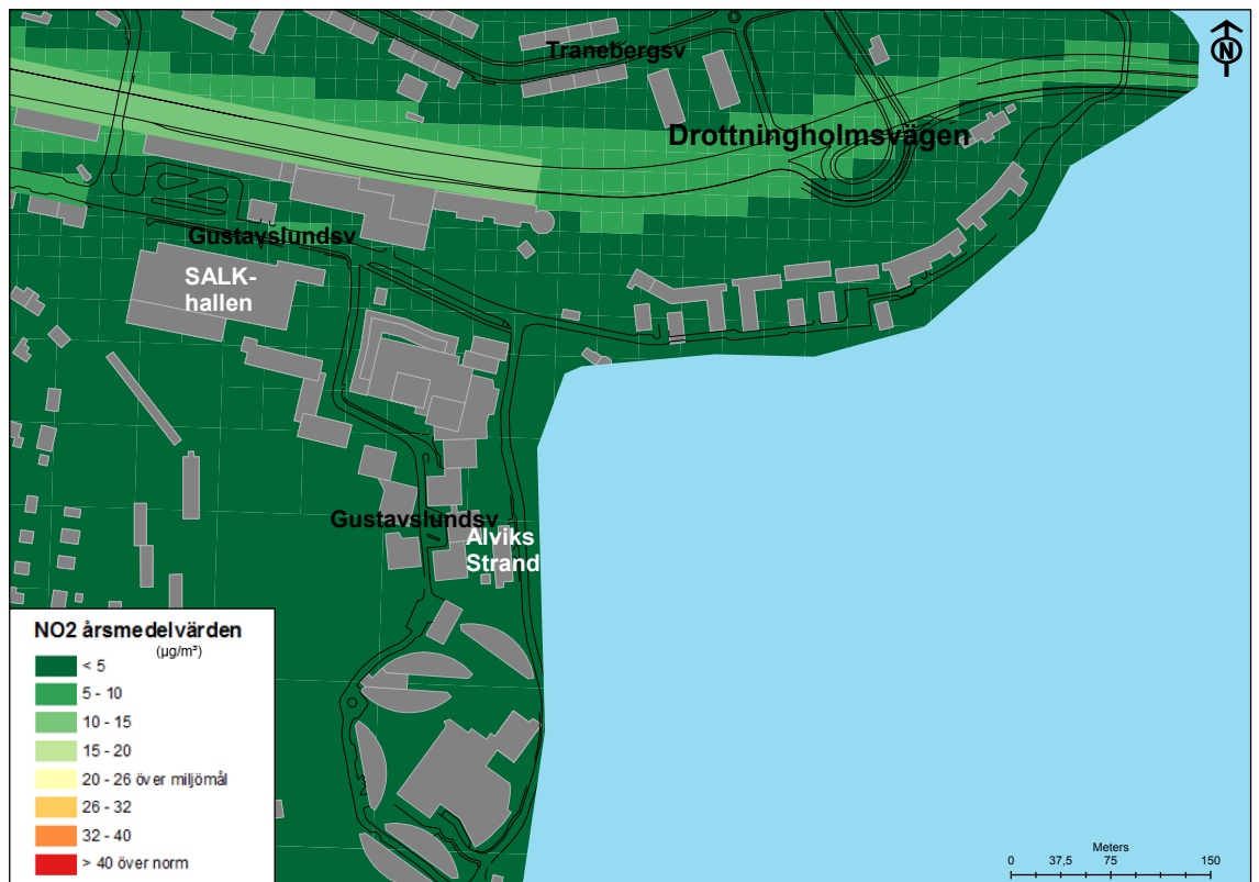
Figur 9. Årsmedelvärden av NO 2 i µg/m 3 i nollalternativet år 2030. Normvärdet som skall klaras är 40 µg/m 3 och miljömålet 20 µg/m 3 .
