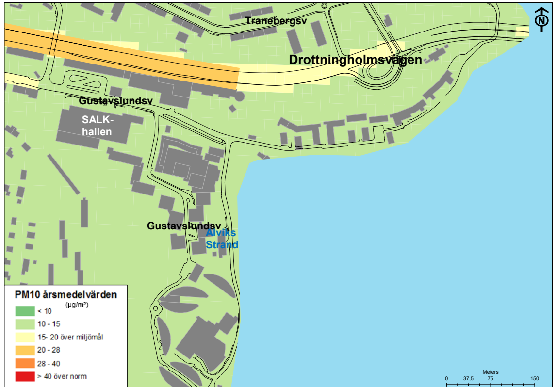
Figur 12. Årsmedelvärden av partiklar PM10 i \mu\text{g}/\text{m}^3 i nollalternativet år 2030 (dubbdäcksandel 50-60 %). Normvärdet som skall klaras är 40 \mu\text{g}/\text{m}^3 och miljömålet 15 \mu\text{g}/\text{m}^3 .
