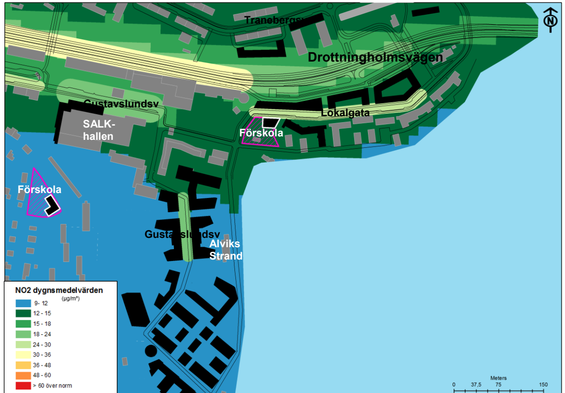
Figur 15. Dygnsmedelvärden av NO 2 i µg/m 3 i efter utbyggnaden år 2030 för de 7:e högsta värdena under kalenderåret. Normvärdet som skall klaras är 60 µg/m 3 .
