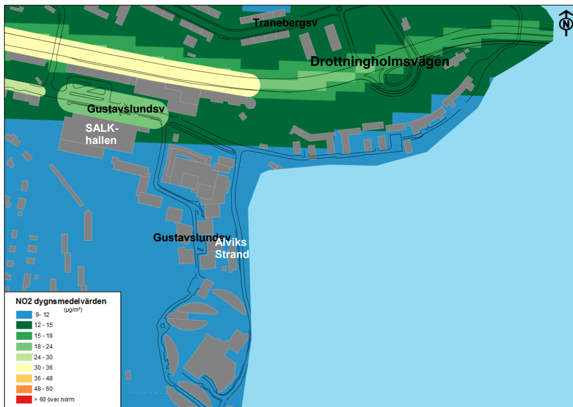
Figur 10. Dygnsmedelvärden av NO 2 i µg/m 3 i nollalternativet år 2030 för de 7:e högsta värdena under kalenderåret. Normvärdet som skall klaras är 60 µg/m 3 .
