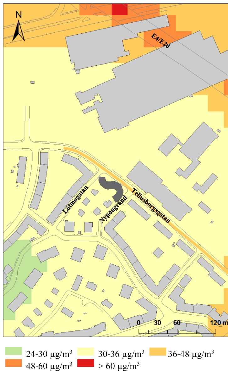
Figur 3. Beräknad dygnsmedelhalt av kvävedioxid, \text{NO}_2 ( \mu\text{g}/\text{m}^3 ) under det 8:e värsta dygnet för utbyggnadsalternativet år 2020. Normvärdet som ska klaras är 60 \mu\text{g}/\text{m}^3 .
