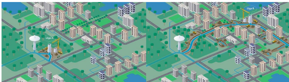
Figur 1 Visar en illustration över omgivningspåverkan kopplat till ledningsarbete. Till vänster för läge (A) där en ny reservoar byggs nära det befintliga huvudvattennätet samt till höger läge (B) där en ny reservoar byggs på ny plats längre ifrån det befintliga huvudvattennätet.
