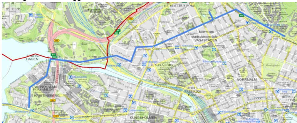
Figur 16. Huvudvattenledning från Lovö vattenverk via Kungsholmen och Vanadislunden till Valhallavägen som helt eller delvis behöver förstärkas visas med blått streck.
