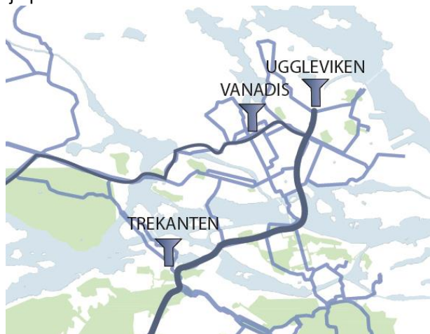
Figur 4 Tjockt blå streck visar huvudvattenledning från Norsborgs vattenverk som passerar reservoaren i Trekanten mot Uggleviksreservoaren. Det lite tunnare blå strecket visar huvudvattenledning från Lovö vattenverk förbi reservoaren i Vanadislund. De två huvudvattenledningarna möts vid Valhallavägen.
