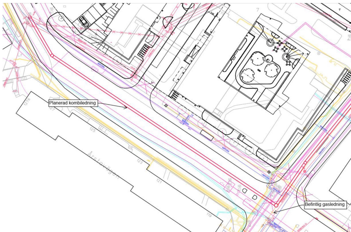
Figur 7. Ledningsomläggning allmän platsmark Årstavägen.
