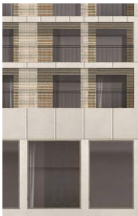
Utsnitt Plåtfasad. Växlingar i indelning skapar variation och bryter ner skalan. Trä vid indragna entréer och balkonger ger en varm inbjudande känsla.
