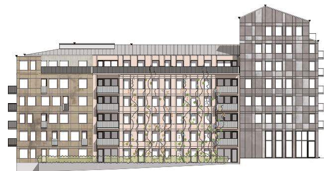
Fasad mot Persikoparken 1:600. Infärgad betong som bildar ett horisontellt mönster och döljer elementskarvar. Lokal i hörn mot Barnängsgatan.
