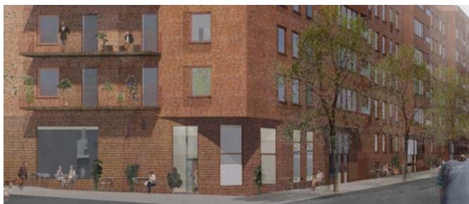
Burspråk och balkonger med begränsat uthäng. Exempel från kv 1B.
