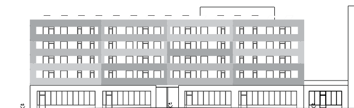
BILD 4:6:4 Fasaden delas in i fyra enheter som tar ner skalan och ger ett mer vertikalt uttryck.
