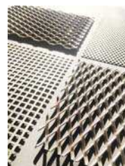
BILD 4:6:6 Räcken av perforerad metall och sträckmetall med samma materialitet ger rusticering av balkongräckenas yta.
