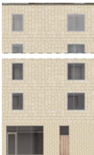
Stående och liggande tegel skapar variation och döljer elementskarvar. Bottenvåningen omhändertags särskilt genom platsmurat tegel. Exempel från kv 3.
