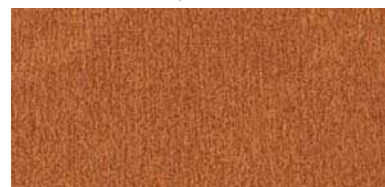
Balkongfronter: perforerad rosttrött stål eller likvärdig metall
