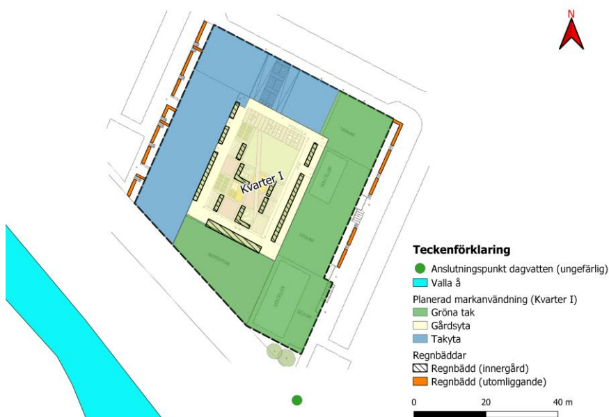
Figur 10-1. Planerat dagvattenhanteringssystem för utredningsområdet Kvarter I (regnbäddar och gröna tak).
