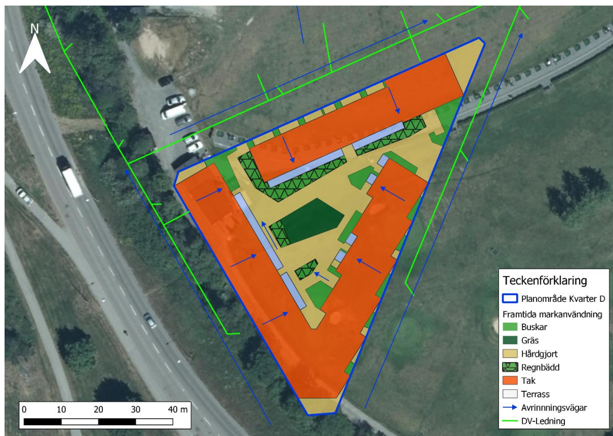
Figur 6-1. Principlösning för dagvattenhantering inom Kvarter D, Årstafältet.
