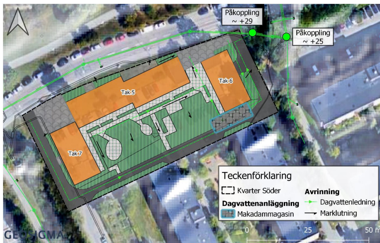
Figur 7-2. Skiss över föreslagen dagvattenlösning inom kvarter Söder.
