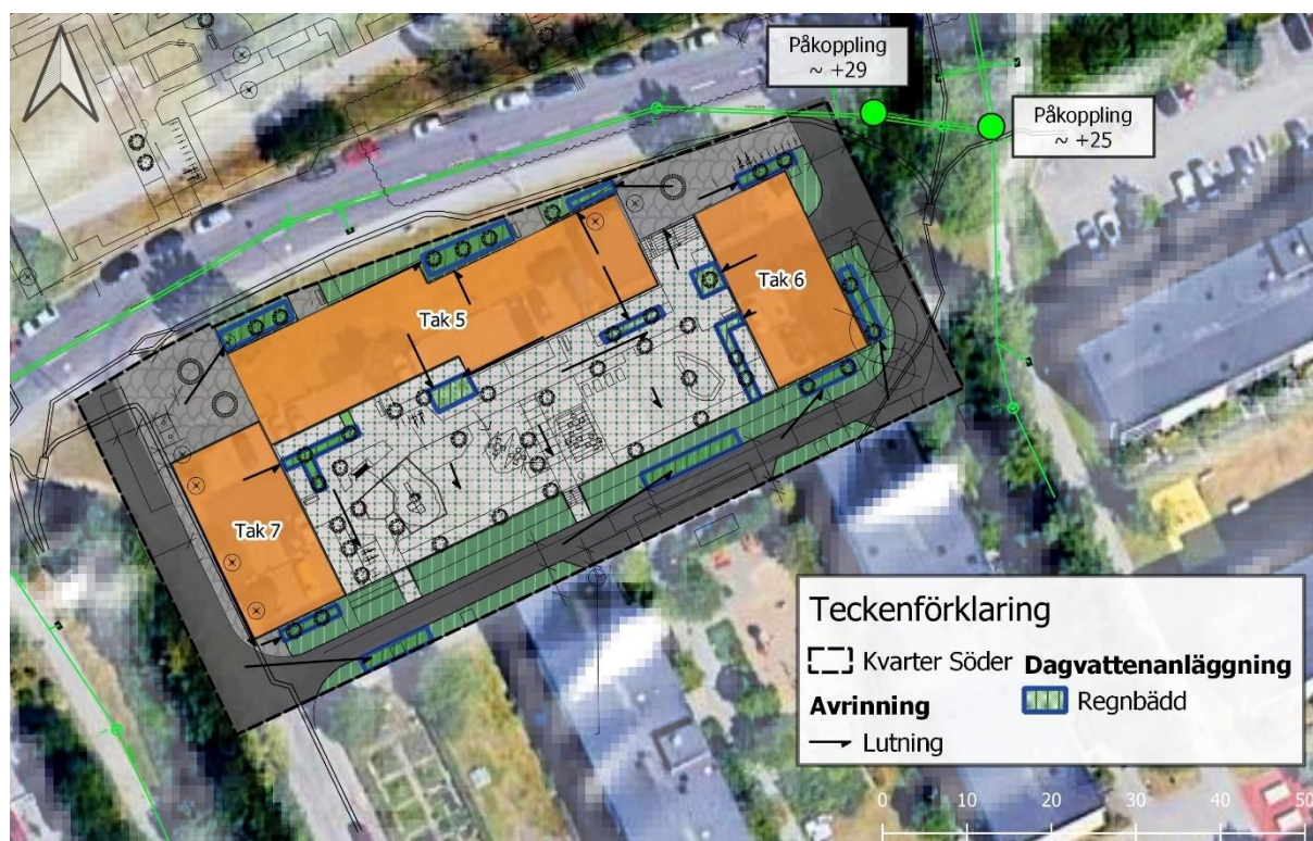
Figur 7-2. Skiss över föreslagen dagvattenlösning inom kvarter Söder.
