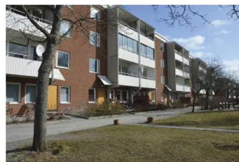
Trevåningshus med suterrängvåning mot söder. Husen är klädda med rött fasadtegel och har balkongfronter och takfot i trapetskorrugerad lättmetallplåt.
