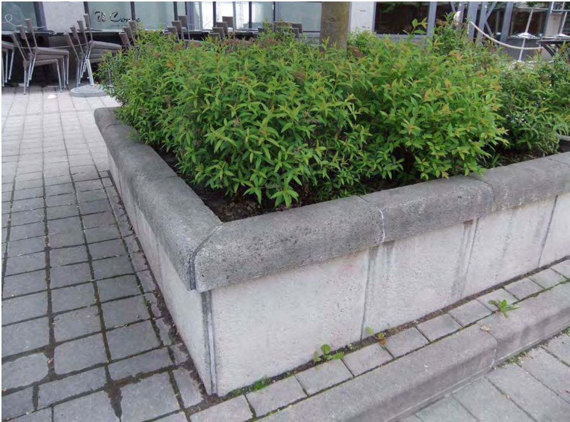
1 Tydliga gångstråk och möbleringszoner med trädplateringar delar in ytorna 2 Specialtillverkade betongmurselement med sittbar kant runt upphöjda växtbäddar 3 Geometriskt placerade lindträd vid trappan som leder upp till Arenagångarna från Arenavägen
