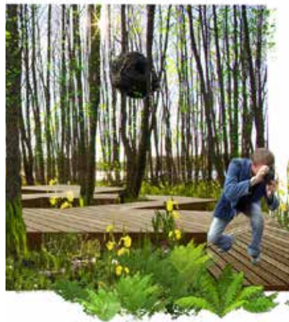
Figur 21. Gångvägar som berör våtmarker eller stränder bör utformas som spänger. Spängerna kanaliserar människors rörelser och minskar slitaget på vegetationen. Spängerna ska utformas så att de inte hindrar groddjurs vandringar mellan lekplatser och övervintringsområden.
