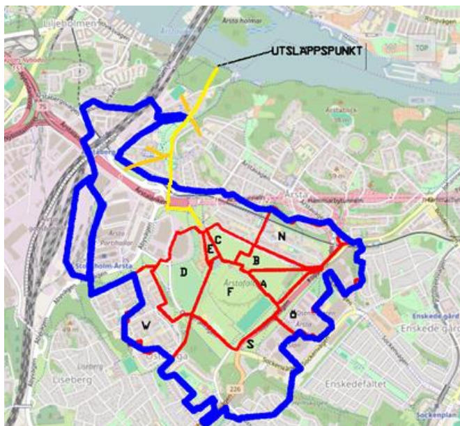
Figur 1: Blå linjer visar avrinningsområde till Årstatunneln. Röda linjer visar avrinningsområde som leds via damm. Område N avrinner i nuläget inte via damm, men kommer att ledas till planerad damm. Den gula linjen är ungefärlig position av Årstatunneln och dess (orange) anslutningar.
