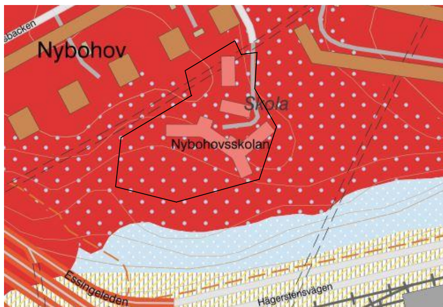
Figur 2. Söder om fastigheten påträffas morän. Vid utförd undersökning påvisades fyllnadsmassor i huvudsak bestående av grusig sand, men också bestående av mullhaltig sand alternativt mullhaltig sandig lera. Enligt SGU bedöms jorrdjupet vara 0 meter.
