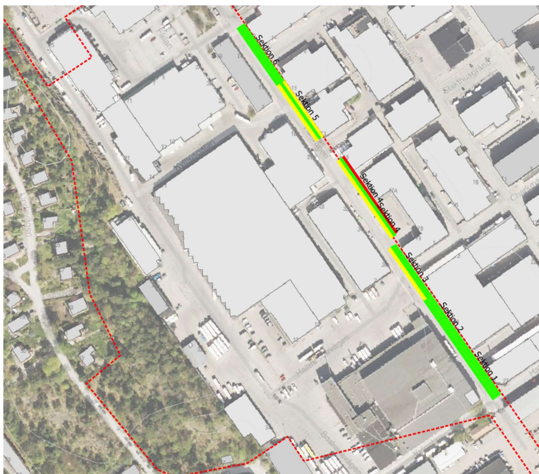
Figur 9 Resultat från slutprover i schaktväggar och schaktbotten vid tillfällig ledningsomläggning på Hallvägen. I varje sektion togs ett samlingsprov på västra väggen, schaktbotten och på östra väggen. Ledningsomläggningen genomfördes på olika sidor av Hallvägen vilket resulterar i att schakten markeras på olika sidor om vägen. Grönt - halter under KM, gult- halter mellan KM och MKM, rött- halter över FA. Styrande för klassning är PAH-H.
