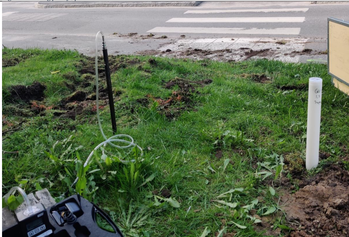
Figur 8: Porluftpåmätning punkt P1 och nedsatt GV-rör, GV1.
