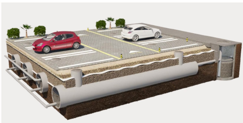
Figur 2. Principskiss över uppbyggnad av Weren:s system med rörkassettfiltren i kombination med lättklinker. Rening sker via kalkfiltermaterial i rörkassetterna och magasinering i lättklinker (Källa: Sam Ekstrand, Weren ©).
