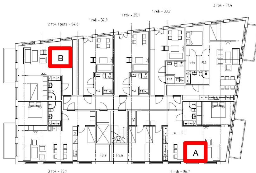
Figur 2 - Mätpunkterna A och B är utmarkerade på planerat normalplan. Mätpunkt A var på ett betongfundament i lös mark och mätpunkt B var på bergknalle.
