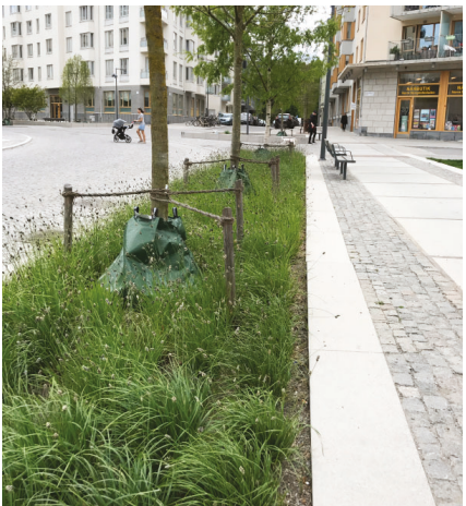
Dagvatten leds bland annat till urbana växtbäddar längs Selmedalsvägen
