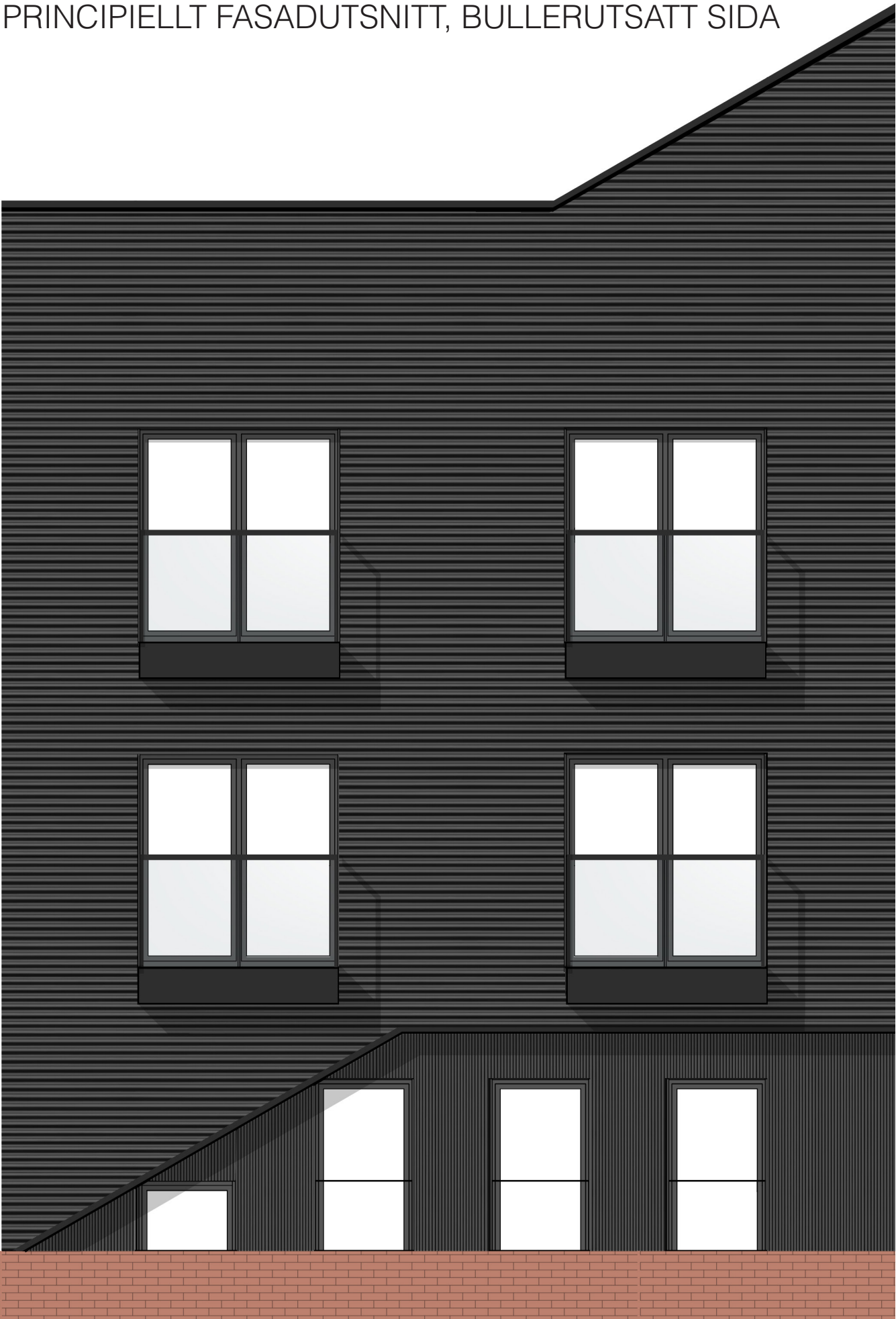
Fasadutsnitt Skala A3/ 1:50 Balkong med glasträcke och eventuellt absorbent i undersida balkongplatta
